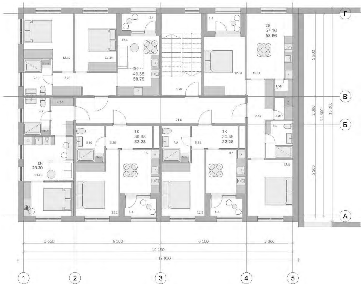
Рисунок 1.11 – Архітектурне об’ємно-планувальне завдання п’ятиповерхової секції для порівняння різних конструктивно-технологічних схем [4]
